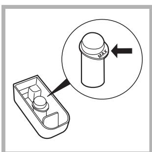
Tegye be a 4-es berakható tartályt az 1-es rekeszbe. A fehérítőszer betöltése közben vigyázzon arra, hogy az a központi csapon jelzett "max" szintet ne haladja meg (lásd ábra).
